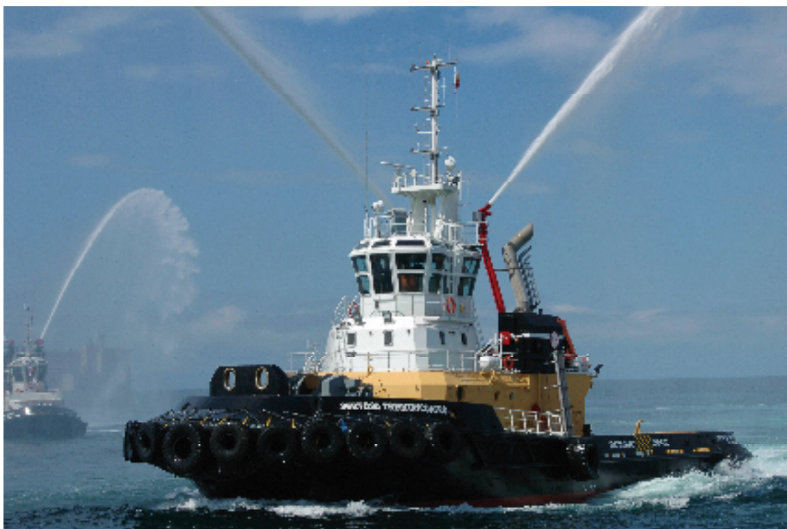
“SERTOSA TREINTAYCUATRO” - Remolcador de altura y salvamento. (Sertosa Norte, S.L.) - Ibaizabal Management Services, S.L. Año de construcción 2008 - 785 GT - 8.000 CV de potencia
