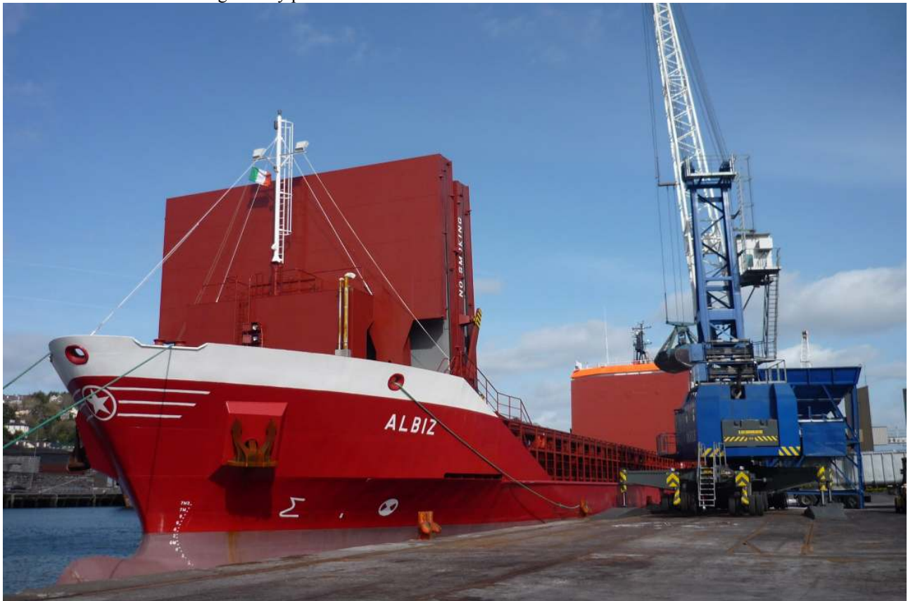
“ALBIZ” - Naviera Murueta, S.A. Bulk carrier - carga seca y portacontenedores - 3.988 GT/5.700 TPM - Año de construcción 2008
