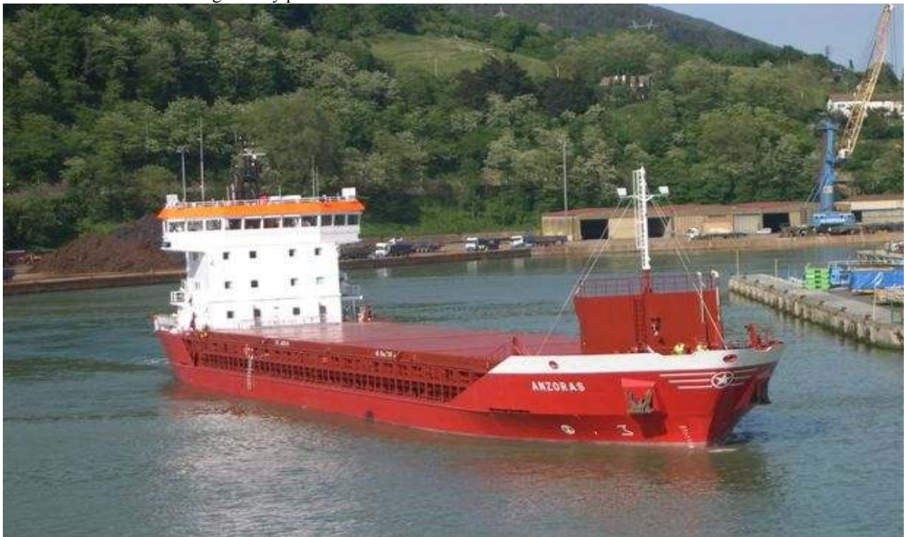
“ANZORAS” - Naviera Murueta, S.A. Bulk carrier - carga seca y portacontenedores - 3.988 GT – 5.700 TPM - Año de construcción 2008
