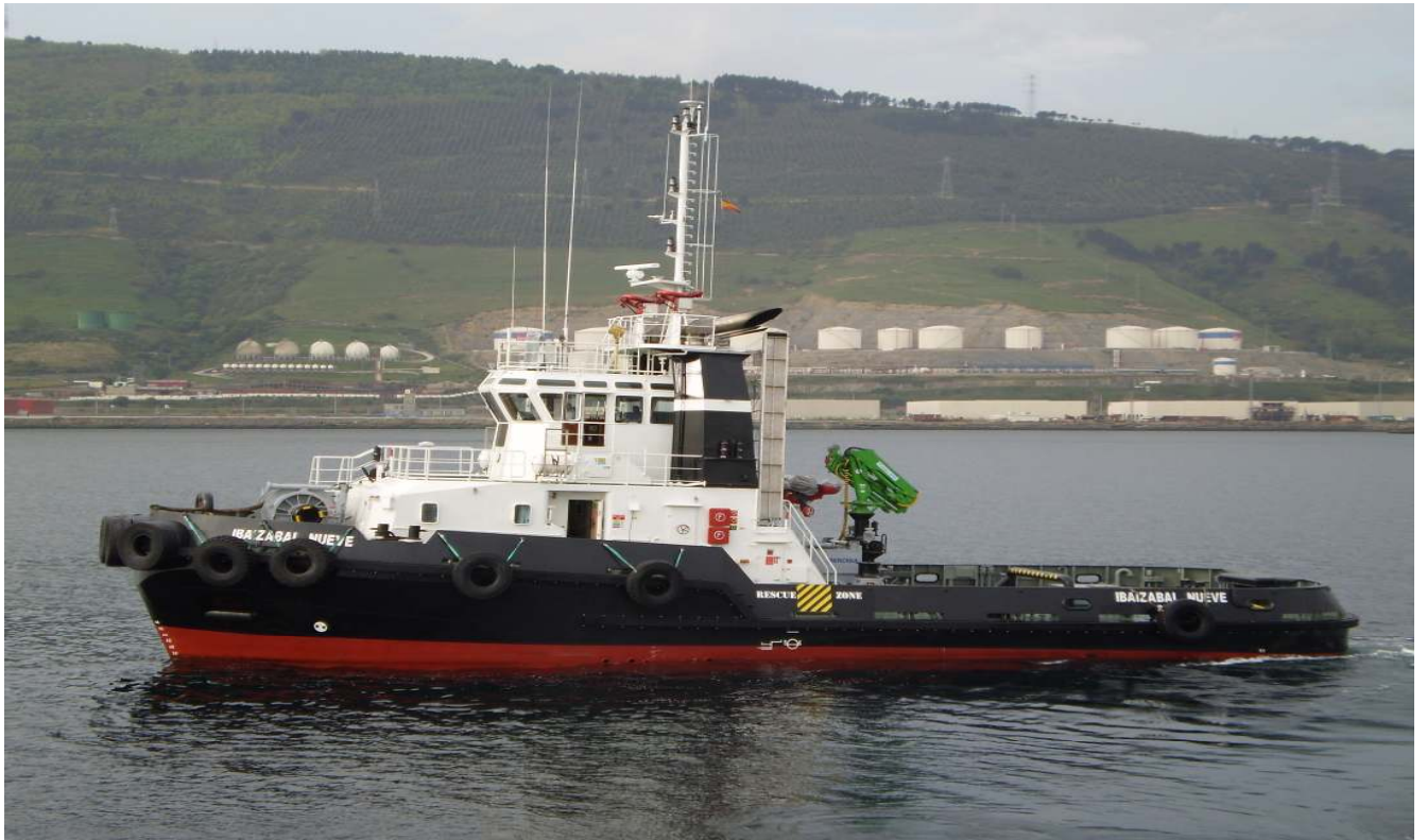
“IBAIZABAL NUEVE” - Remolcador de altura y salvamento. 428 GT - 5.364 C.V. de potencia - Año de construcción 2010 (Cia. de Remolcadores Ibaizabal - Ibaizabal Management Services, S.L.)
