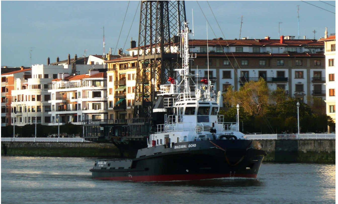
“IBAIZABAL OCHO” - Remolcador de altura y salvamento. 428 GT - 5.364 C.V. de potencia - Año de construcción 2010 (Cia. de Remolcadores Ibaizabal - Ibaizabal Management Services, S.L.)
